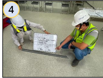
鋼筋材料監造查證取樣
